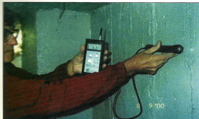
Figura 5 - Misure di resistività con la sonda di Wenner
